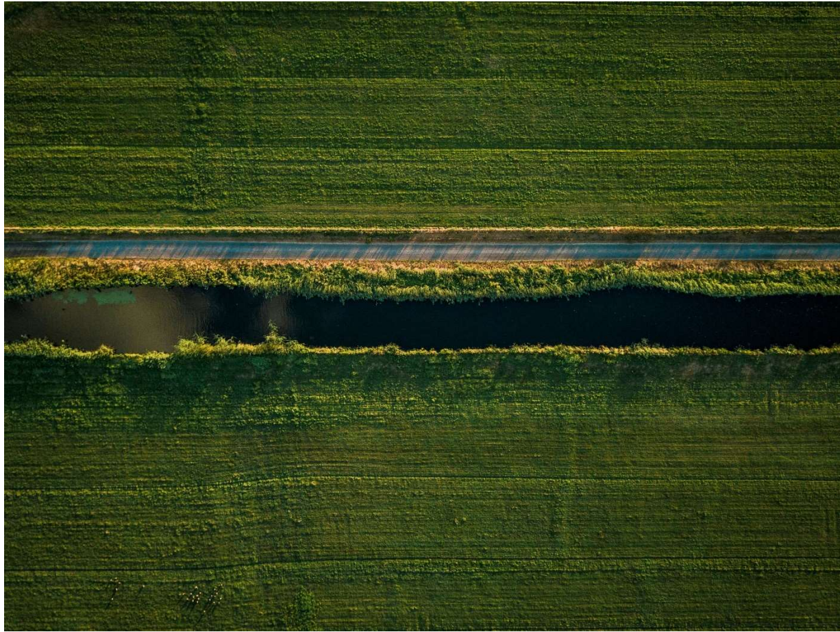
En gravet kanal leder vandet væk fra både mark og vej og ned i kanalen i stedet. Det kaldes at dræne området.
